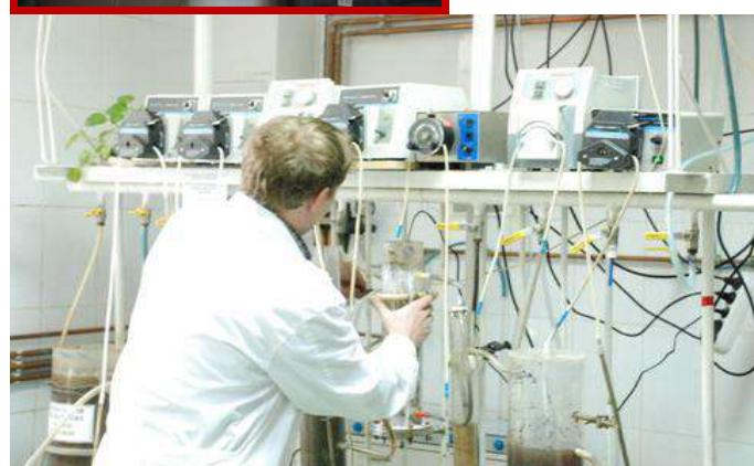
*Instalatii model utilizate in experimente pilot de laborator pentru tratare /epuarare ape*
