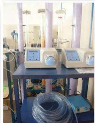
**Instalație model de epurare biologică cu strat fluidizat**
