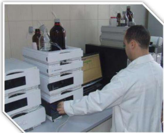
**Ion cromatograf Dionex 5000 cu detectori UV VIS si de conductivitate**
