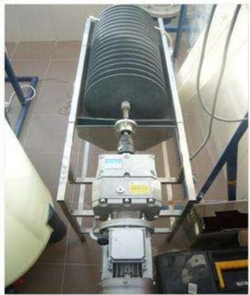
**Instalație model de epurare biologică cu biomasă fixată tip biodisc**
