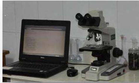
**Stereomicroscop trinocular cu interfata la PC**
