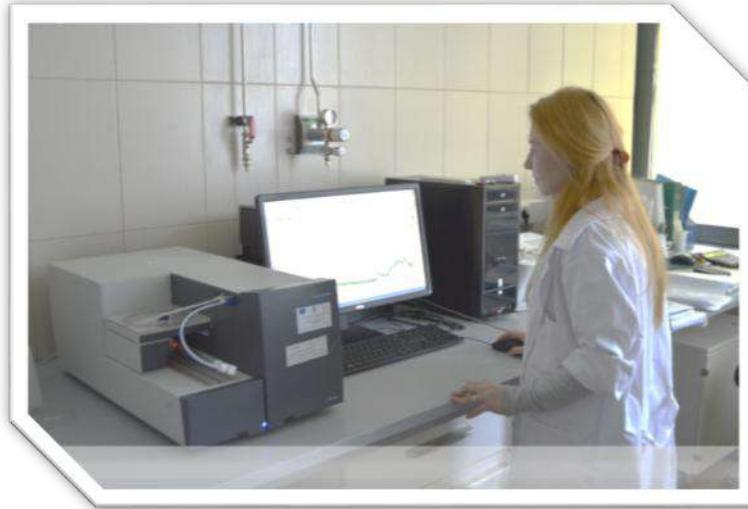
**Analizorul Trase Elementar Instrument** se utilizează pentru determinarea conținutului de compuși organici halogenăti adsorbabili (AOX), ce conțin clor, brom și iod (dar nu și flor). Principiul metodei constă în adsorbția halogenurilor organice prezente în apă sau nămol, pe cărbune activ, arderea acestuia într-un current de oxigen și determinarea ionilor de halogenuri prin titrare argentometrică, rezultatele fiind exprimate în concentrație masică de clorură.
