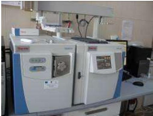
**Gaz cromatograf cuplat cu spectrometru de masa**
