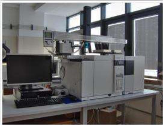
**Cromatograf de gaze cuplat cu spectrometru de masa – GC-MS, 240 ION TRAP GC/MS**
