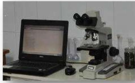
**Stereomicroscop trinocular cu interfata la PC**
