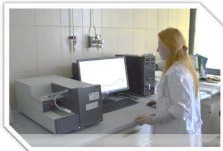
**Analizorul Trase Elementar Instrument** se utilizează pentru determinarea conținutului de compuși organici halogenatați adsorbabili (AOX), ce conțin clor, brom și iod (dar nu și flor). Prințipiu metodei constă în adsorbția halogenurilor organice prezente în apă sau nămol, pe cărbune activ, arderea acestuia într-un curent de oxigen și determinarea ionilor de halogenuri prin titrare argentometrică, rezultatele fiind exprimate în concentrație masică de clorură.
