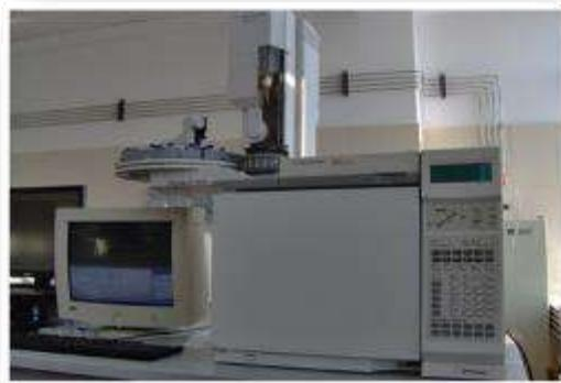
**Cromatograf de gaze cu detecție ECD/FID**
