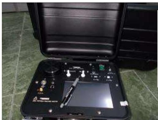
**Analizor automat pentru determinarea radonului Pylon AB6**
