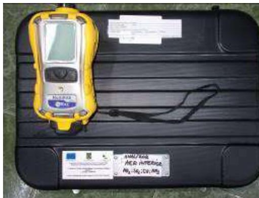
**Analizor automat pentru aer de interior MultiRae**
