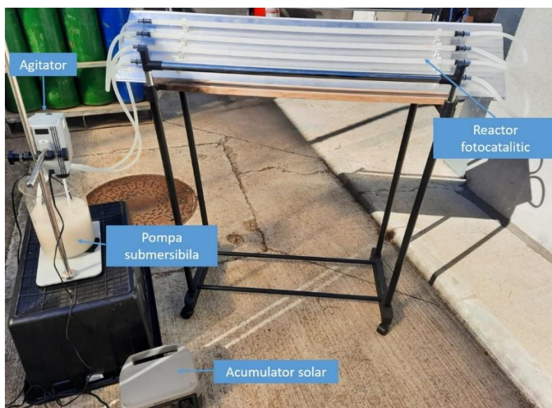
Instalatie fotocataliza solara
