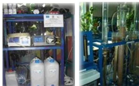
Instalație model de epurare biologică cu biomasă fixată
