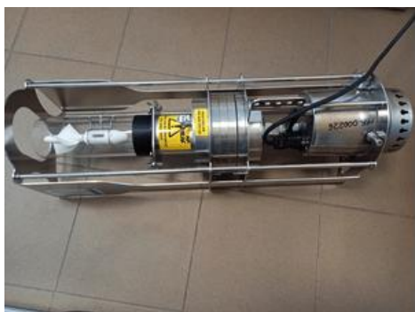
Pompa portabila pentru prelevarea microplasticelor din ape
