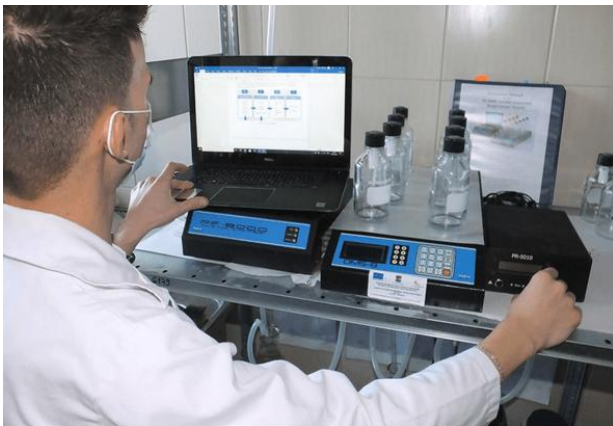
Instalatie pentru teste respirometrice (rata de respiratie a namolului activ in prezenta toxicului)
